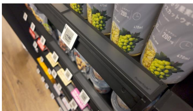
複数の電子棚札にレール単位で給電・通信するソリューション
